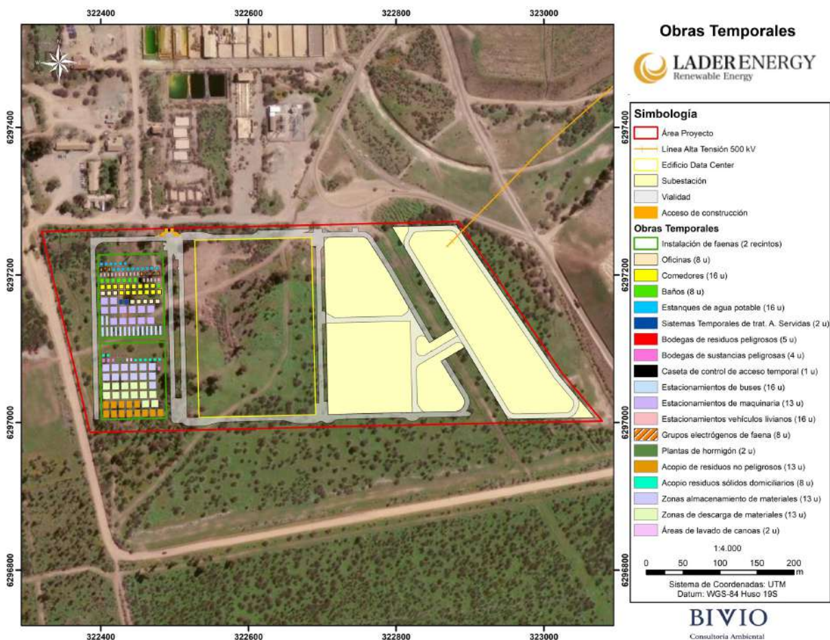
Figura 5. Obras temporales: recintos de personal y de materiales al interior del cerco perimetral.
