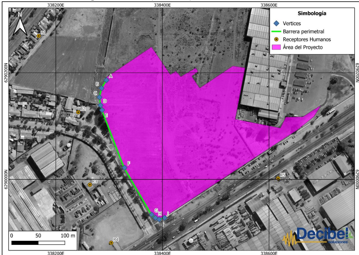
Figura F.6: Barrera perimetral para fase de construcción.
