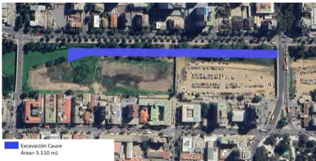
Figura N°25: Excavación Cauce Fuente: Elaboración propia, 2025.
