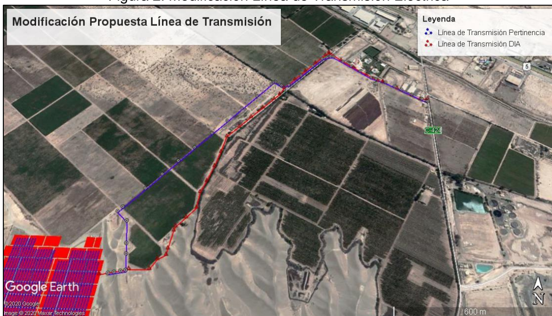
Figura 2. Modificación Línea de Transmisión Eléctrica
