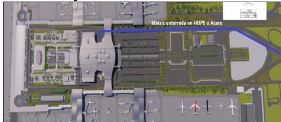
Imagen N°1 “Ubicación de sistema de tuberías”
