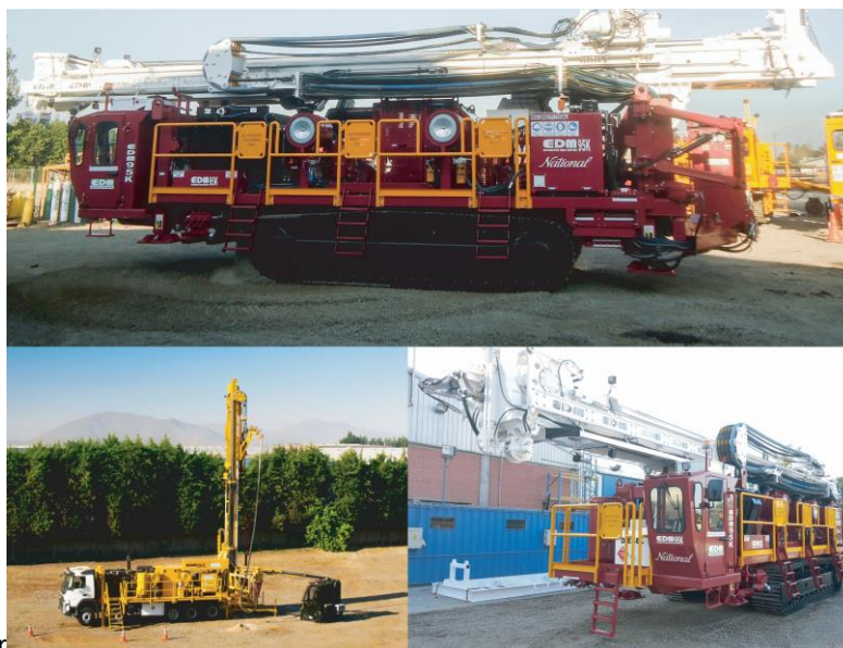
Figura 4- Equipo de perforación tipo Coring / Multipurpose Rig
