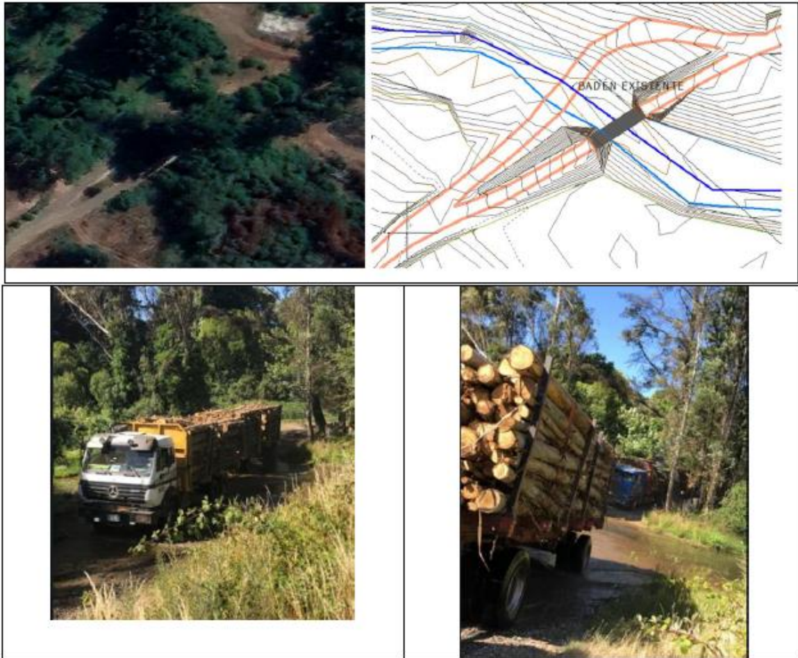
Figura 4 Ubicación del Puente proyectado y Uso Actual del badén existente. Abajo se observa badén actual en uso.
