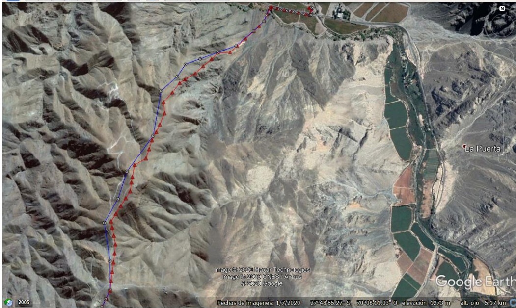
Figura 1: Tramo del trazado de la LTE modificado (en azul), mientras que en rojo se observa ubicación según proyecto original.
