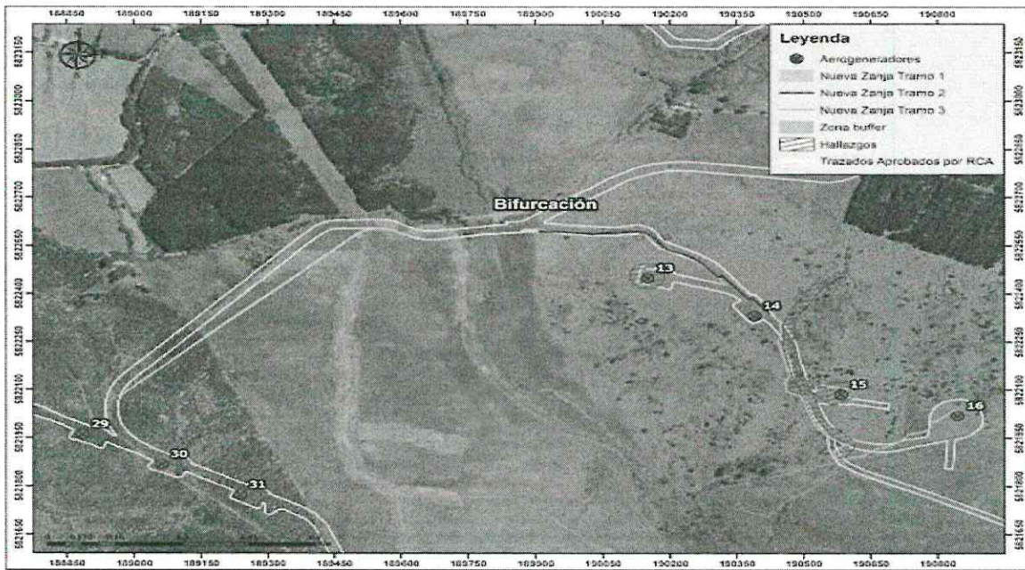
Figura N° 5. Construcción de zanjas eléctricas de media tensión entre AG 29 y AG 16.
