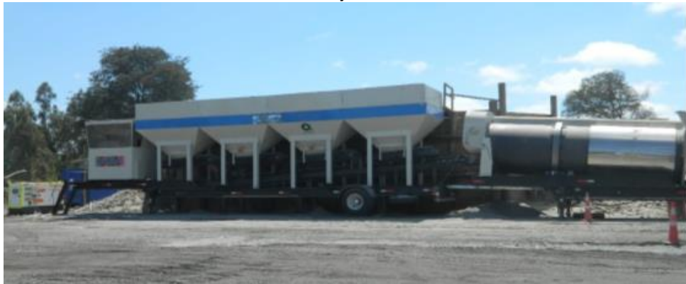
Figura 3-2: Fotografía de la Planta de Asfalto similar a la instalar- Vista de los buzones y horno de secado
