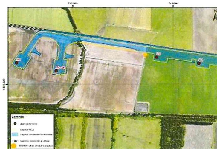
Figura 8 Modificación caminos de interconexión entre aerogeneradores D4, D3, AG-20 y D2.
