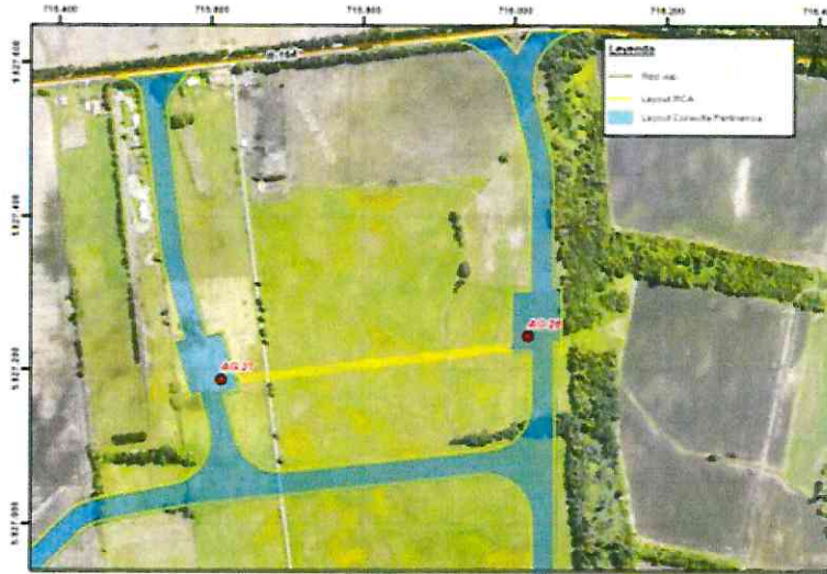
Figura 16 Eliminación de trazado de canalización eléctrica entre aerogeneradores AG27 y AG28
